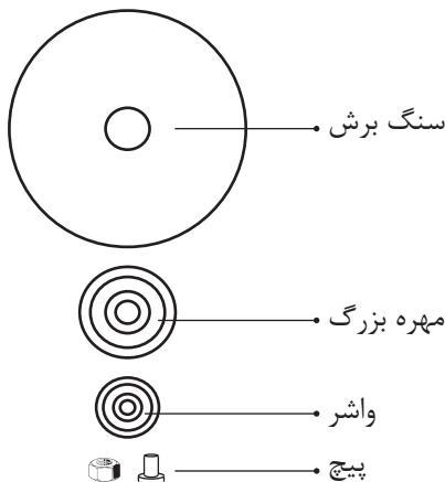
در صورت کوچک شدن صفحه برش با تنظیم ارتفاع پیچ آلن و کنترل زاویه برش می توان از سنگ به صورت بهینه تر استفاده کرد.
