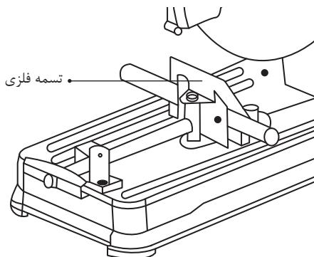
برای برش قطعه کارهای بلند، دو پایه غیر قابل اشتعال در دو طرف قطعه کار قرار داده و قطعه کار را نیز با فک ثابت و متحرک به خوبی محکم نمایید و توجه نمایید که هر سه سطح در یک راستا باشند.
