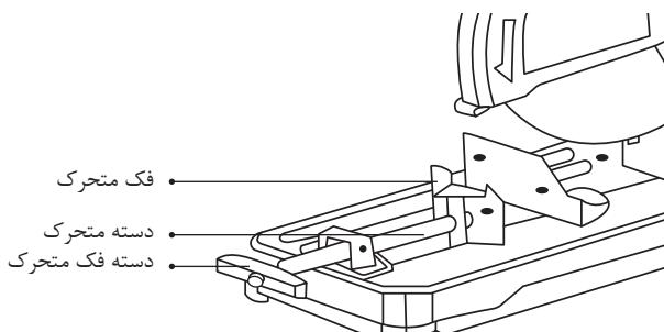
هنگامی که سنگ برش کهنه شد، با قرار دادن یک تسممه فلزی غیرقابل اشتعال پشت قطعه کار، از لبه های داخلی سنگ برش نیز می توان به طور بهینه استفاده کرد.
